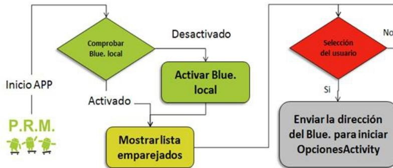
Figura 3. Diagrama en bloques “Devicelist”
