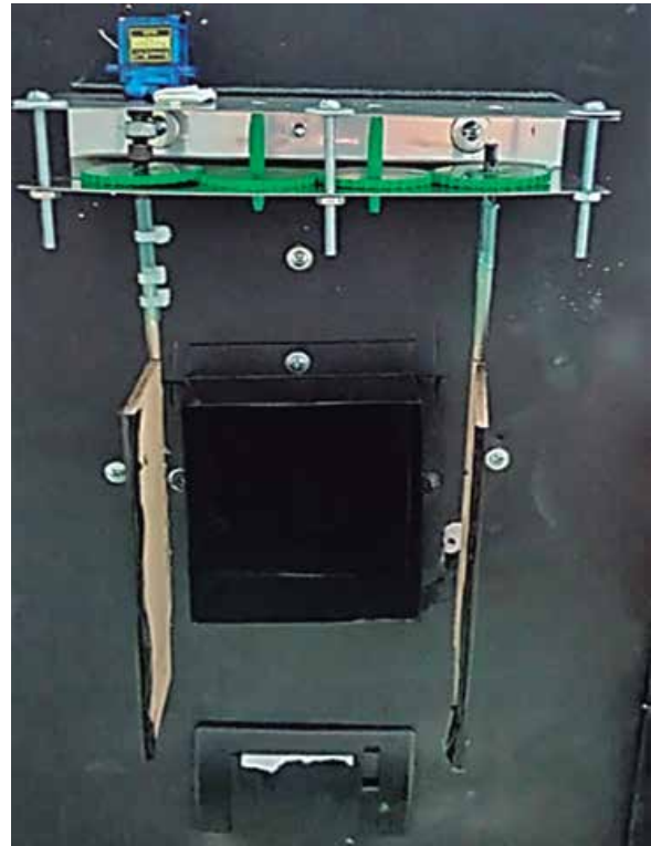
Fig. 8. Compuertas de ingreso y tren de engranaje Fuente: Elaboración Propia
