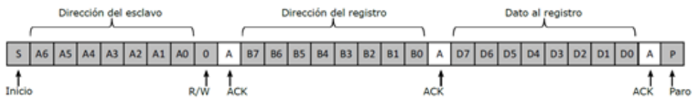
Figura 2. Proceso de escritura I2C en el registro del dispositivo esclavo Fuente: Texas instruments (2015).
